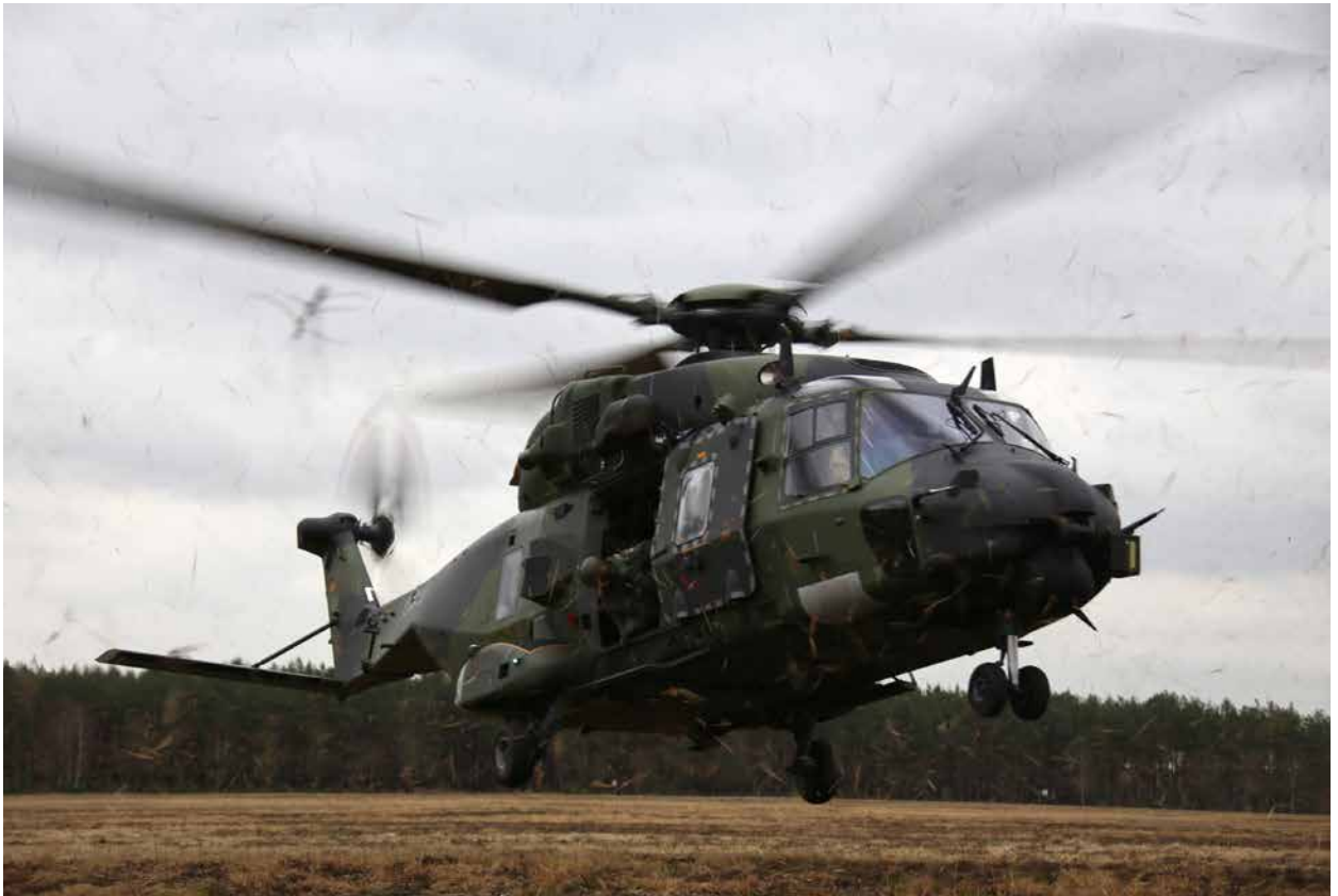
So knapp über dem Boden wird die Kraft des Downwash deutlich spürbar. Nichts darf mehr ungesichert herumliegen.
